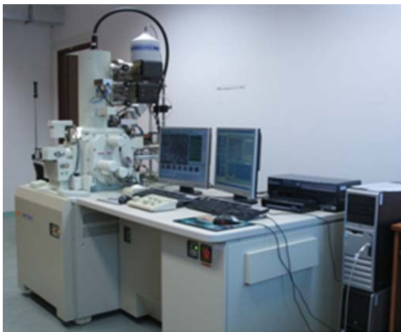
SEM (Jeol JSM-7500F z przystawką EDS-INCA PentaFETx3)
